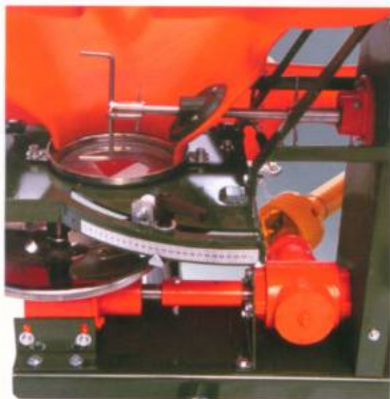
Agitador horizontal acionado por caixa de transmissão reduzida
