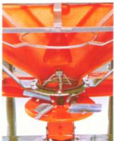
Eccentric mixer with Chinese hat Agitador excêntrico com cobertura cônica "sombbrero chino".
